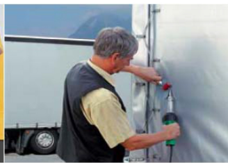
Soldadura de reparación de una lona de camión con TRIAC PID, boquilla de ranura ancha y rodillo de presión.
